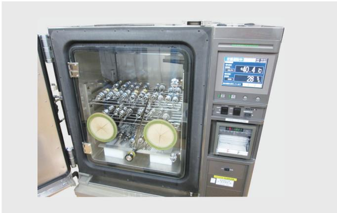
熱安定性試験（恒温槽）外観
